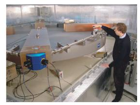
FIGURE 91 A modern precision ring laser interferometer (© Bundesamt für Kartographie und Geodäsie, Carl Zeiss).
