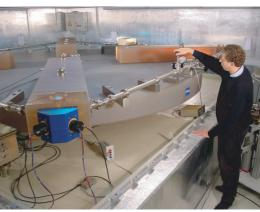
FIGURE 105 A modern precision ring laser interferometer (© Bundesamt für Kartographie und Geodäsie, Carl Zeiss).
